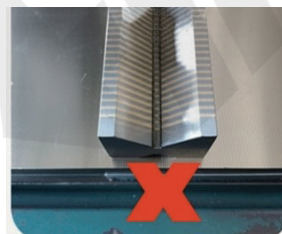
導磁架磁條與磁片磁條方向放置不一致，導磁架不導磁
